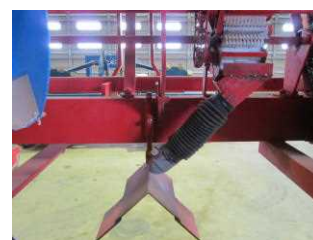
肥料が2方向に落ちる ように排出口を改造
